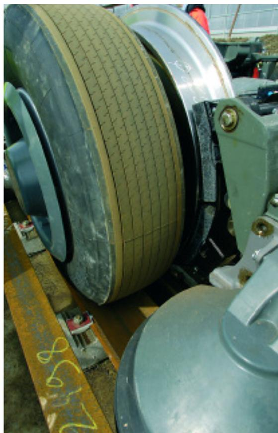
La topographie a déterminé le choix du pneu pour les véhicules m2. C'est la seule solution d'adhérence qui permette d'atteindre la vitesse de 60 km/h tout en autorisant le franchissement des pentes de 12% du tracé.
